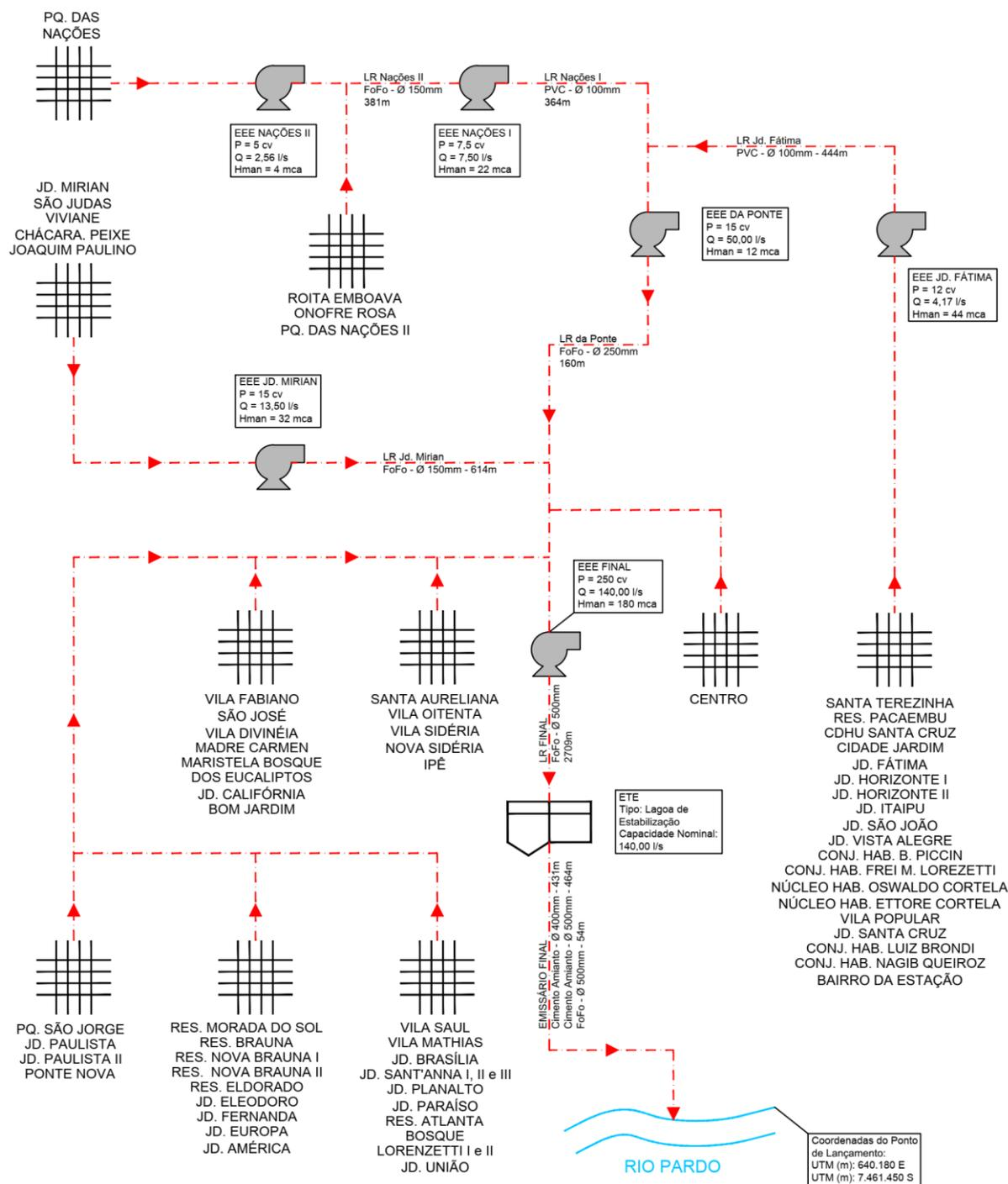
Figura 4.5 – Croqui do Sistema de Esgotamento Sanitário Existente – Sede Urbana
